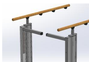
Rys. 2: Barierek automatyczna (wyposażenie dodatkowe) podnosi się i blokuje
